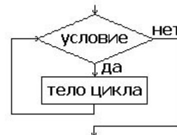
Так же как при использовании цикла `for` и оператора `if`, после служебного слова `do` предполагается только один оператор. Если в теле цикла нужно выполнить несколько операторов, оно оформляется как блок `begin ... end`.
